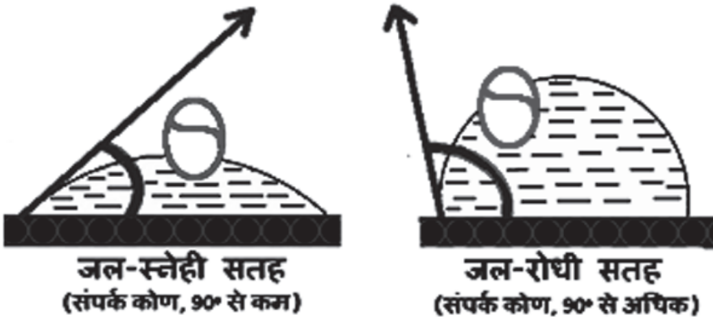
चित्र 2 – संपर्क कोण के आधार पर हाइड्रोफिलिक (जलस्नेही) और हाइड्रोफोबिक (जल-रोधी) सतहें
