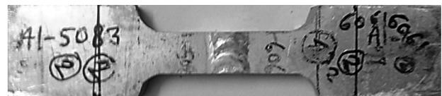
Fig. 2 — Tensile test specimen.
