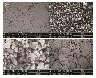
Fig. 1 — Microscopic images of (a) AZ91Mg-alloy, (b) Titanium carbide, (c) Alumina, and (d) AZ91/TiC/Al $_2O_3$  hybrid composite
